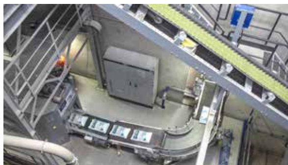
Das gemahlene Glas auf dem Förderband (hellgrün) wird in Säcke abgepackt.
