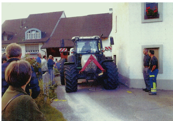
Fahrversuche zur Ermittlung der notwendigen Breite der Einfahrtskurve des Stoltenweges (2011).
